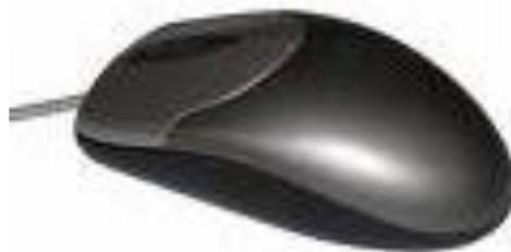
**Ratón o Mouse:** Es un dispositivo electrónico que nos permite dar instrucciones a nuestra computadora a través de un cursor que aparece en la pantalla y haciendo clic para que se lleve a cabo una acción determinada; a medida que el Mouse rueda sobre el escritorio, el cursor (Puntero) en la pantalla hace lo mismo.
