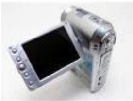
**Cámara de Video:** Graba videos como si de una cámara normal, pero las ventajas que ofrece en estar en formato digital, que es mucho mejor la imagen, tiene una pantalla LCD por la que ves simultáneamente la imagen mientras grabas. Se conecta al PC y este recoge el video que has grabado, para poder retocarlo posteriormente con el software adecuado.
