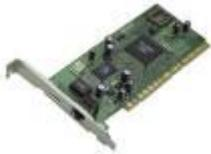
Es el elemento fundamental en la composición de la parte física de una red de área local. Es una interface hardware entre el sistema informático y el medio de transmisión físico por el que se transporta la información de un lugar a otro.
